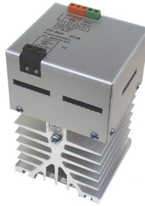
Bei variablem Analogeingangssignal 0-10V 4-20mA oder 0-20mA ermöglichen die PA-Dimmer auf der Lastseite einen Phasenanschnittbetrieb zwischen 0-180 Grad zur Regelung (stufenlos 0-100%) von ohmschen Lasten.; Traforegelung Motordrehzahlregelung Gebläseregelung mit z.B. Spaltpolmotoren von „Torin-Sifan „ oder Kohlebürsten- Motoren getestet bis 1,1KW !!
